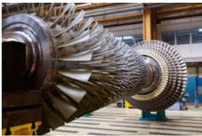
Etage d'une détente dans une turbine : stator + rotor.
