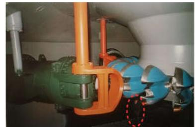
Injecteur : converti l'énergie piézométrique en énergie cinétique.
